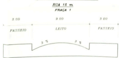
DETALHE SEÇÃO TRANSVERSAL
