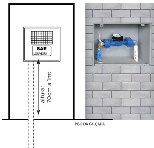
Prepare o muro para a instalação da caixa padrão. Ela deverá ser instalada faceando a divisa frontal do terreno, com altura entre 0,70 cm e 1,00 mt em relação ao piso acabado da calçada.
