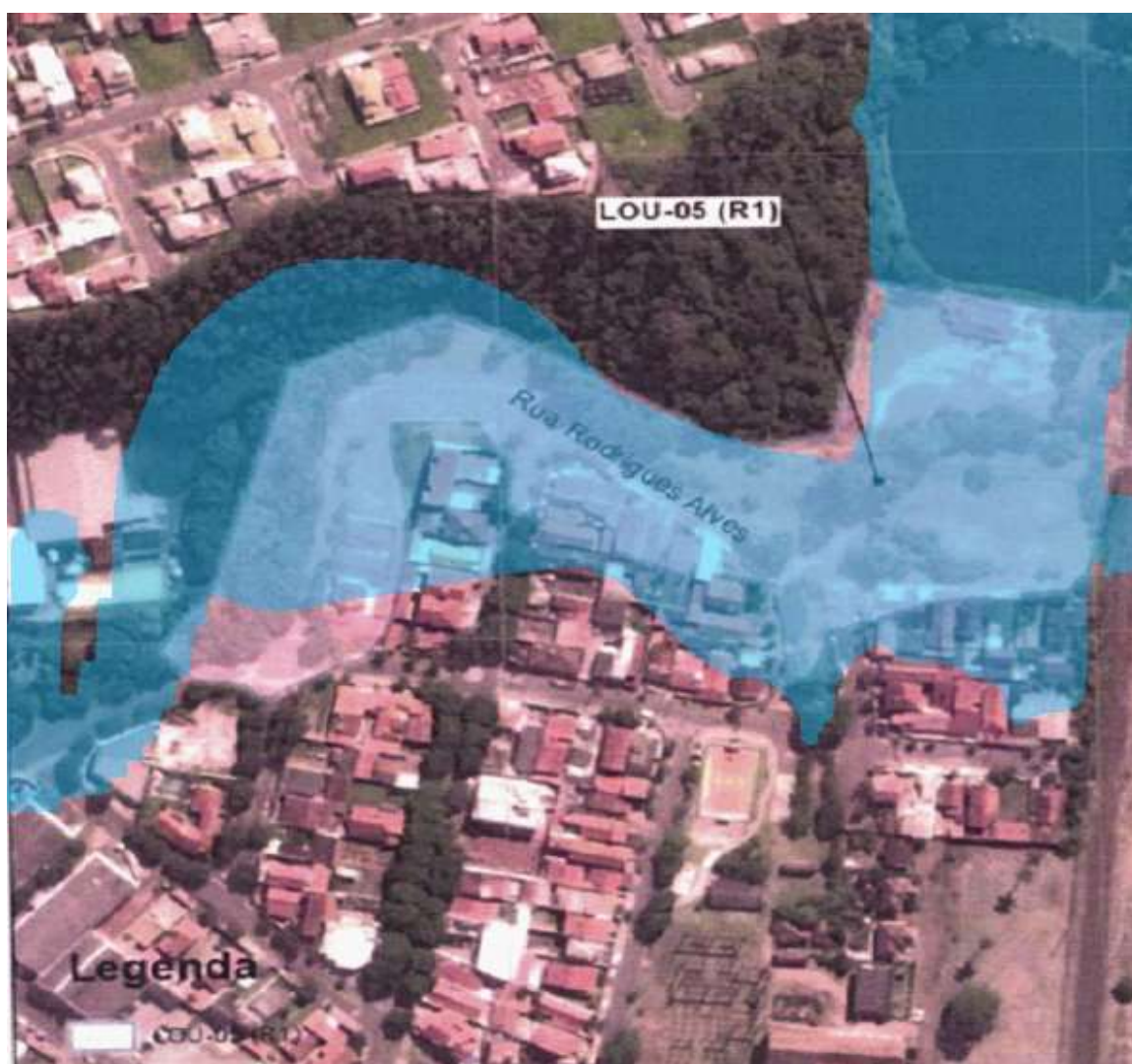
Figura 5.4 – Aferição da rugosidade de Manning – Comparação entre a Área de Risco de Inundação LOU-05 (R1) definido pelo IPT e a mancha de inundação simulada no modelo HEC-RAS para uma cheia de recorrência de Tr=10 anos
