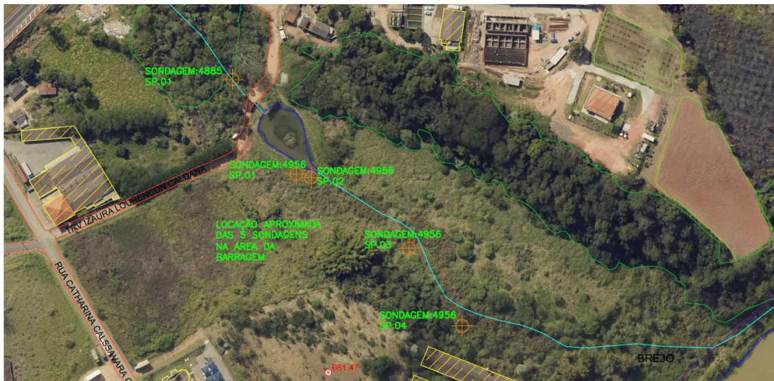
Figura 3.12 – Localização das Sondagens executadas - Solo firme, Engenharia da Fundações LTDA EPP, 2014.
