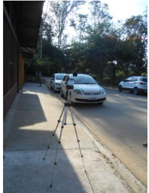
Foto 02: Vista do medidor de nível sonoro com microfone voltado para a direção do futuro anel viário.
